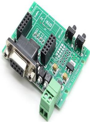
Fig. 5. ZigBee Module
